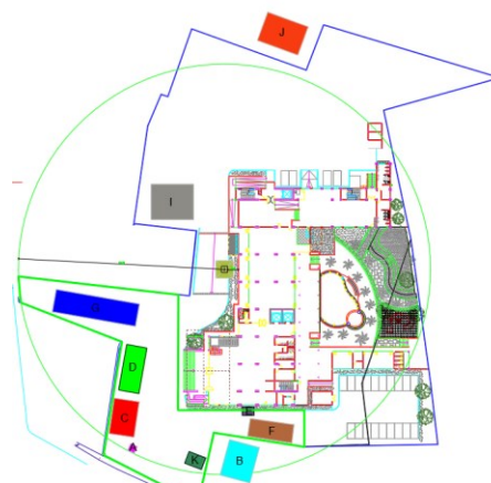
A. Pos security B. Parkir C. Direksi keet E. Alimak F. Gudang semen G. Fabrikasi besi H. Tower crane I. Fabrikasi bekisting J. Barak pekerja K. Washing bay
