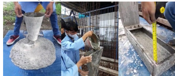
Gambar 2. Pengujian Beton Segar Slump-Flow, V-Funnel Dan L-Box
