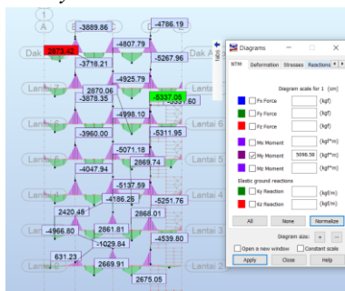
Gambar 6. Momen Balok Induk pada software Robot Structural Analysis
