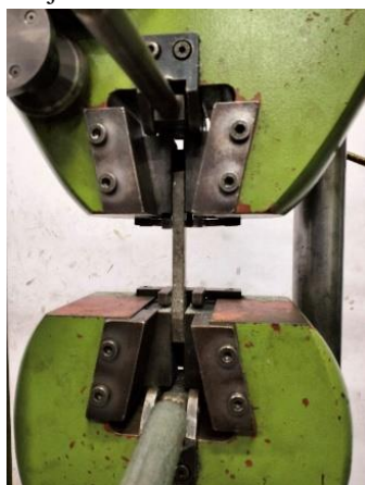
Gambar 2. Proses pengujian tarik
