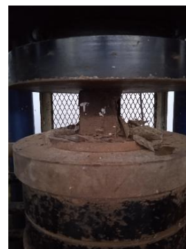
Gambar 1. Pengujian Tekan Kubus 5x5x5 cm
