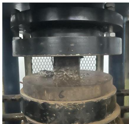
**Gambar 2.** Retakan Saat Pengujian Tekan
