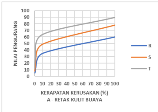
Gambar 1.5 Kurva Nilai Pengurang Kerusakan Retak Kulit Buaya
