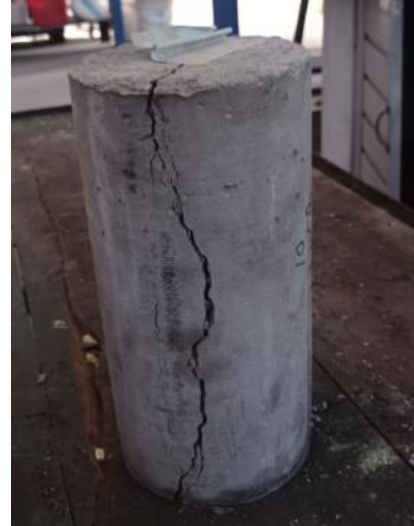
Gambar 6 Retak dalam Benda Uji Silinder
