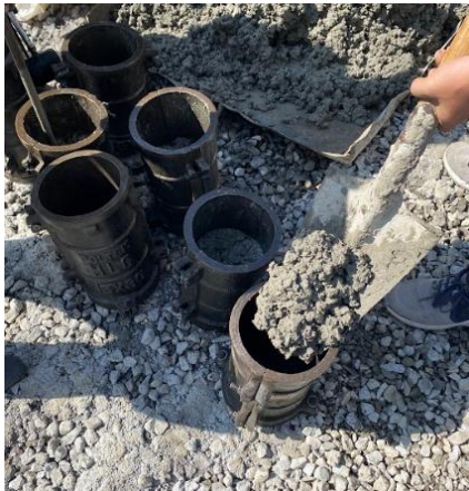
Gambar 2 Memasukkan Beton Segar ke Cetakan
