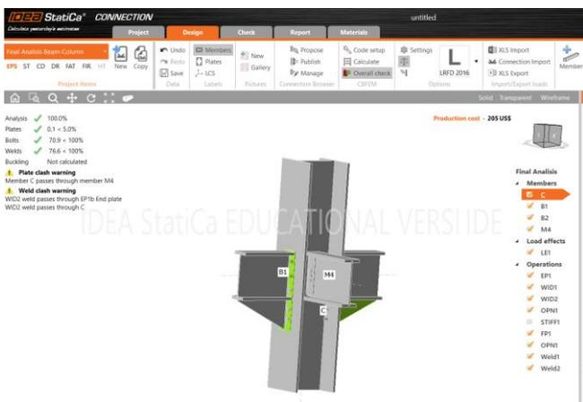
Gambar 8. Modeling sambungan balok-kolom hasil ekspor file dari aplikasi analisis dan desain struktur
