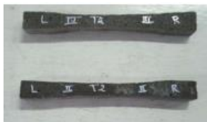
Gambar 4. Desain benda uji tarik
