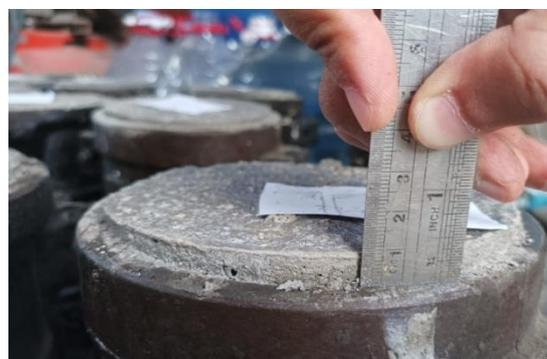
**Gambar 3.** Pengukuran kembang beton
