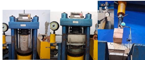
Gambar 2. Metode Uji tekan, tarik, dan geser dinding interlock
