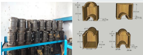
Gambar 1. Benda uji silinder dan interlock
