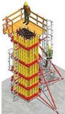
Gambar 12. Perancah bekisting kolom
