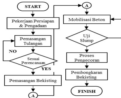
Gambar 13. Flowchart Pekerjaan Parapet dan Median
