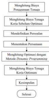
**Gambar 1.** Diagram Alir Perhitungan Optimasi Tenaga Kerja Bekisting
