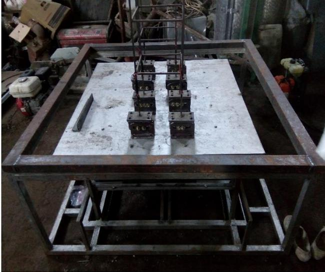
**Gambar 6.** Alat Pengujian Meja Getar
