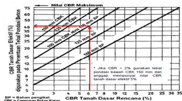
Gambar 4 CBR Tanah Dasar Efektif dan Tebal Pondasi Bawah
