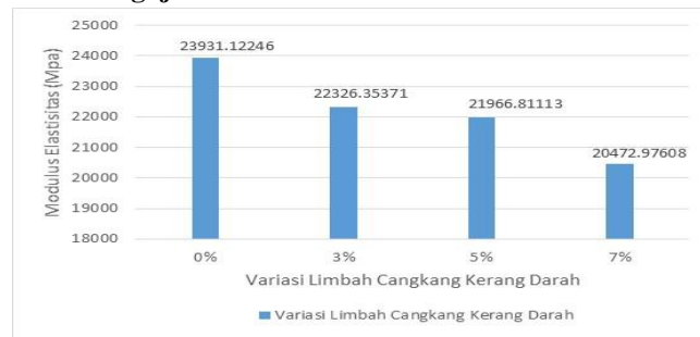
Gambar 2 Grafik Hubungan antara Variasi Limbah Cangkang Kerang Darah dan Modulus Elastisitas Beton
