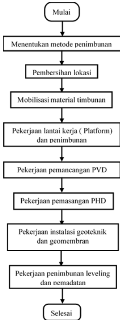
Gambar 4. Diagram alir metode pelaksanaan perbaikan tanah menggunakan metode Preloading dan Prefabricated Vertical Drain (PVD) .
