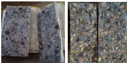
Gambar 6 Perbedaan Visual Antara Kuat Tarik Belah Agregat Lumajang dan Madura Sumber: Hasil Pengujian, 2021
