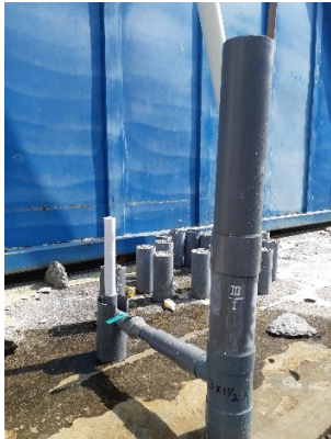
Gambar 3 Hasil modifikasi alat uji Permeabilitas
