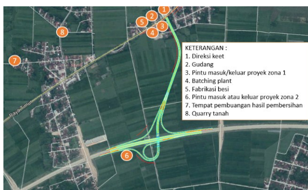
Gambar 4. Site layout dan traffic management Proyek Simpang Susun Sragen Timur
