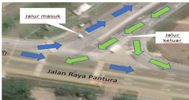
Gambar 4 Traffic management akses keluar masuk proyek
