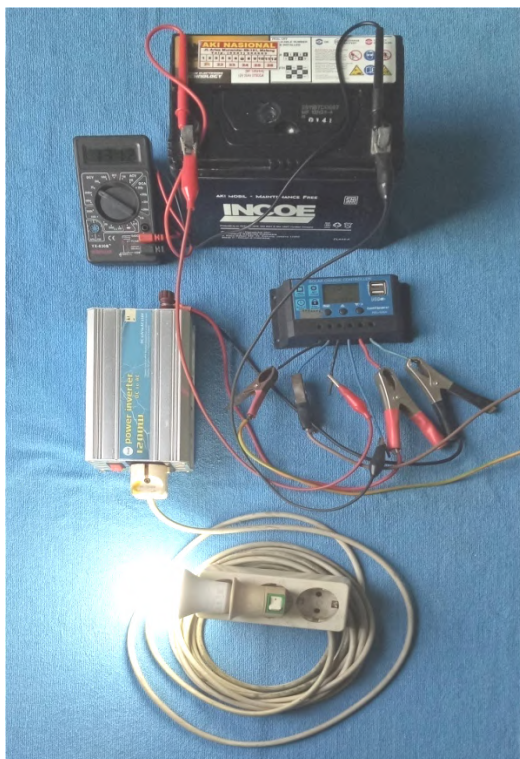
Gambar 15. Panel surya terhubung dengan aki tanpa beban dan beban lampu 12 W
