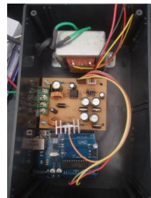
Gambar 5. Implementasi wiring diagram Konverter Cuk.
