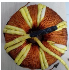
Gambar 6. Trafo yang sudah didesain
