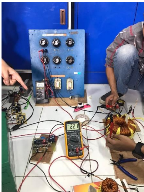
Gambar 9. Bukti Trafo Toroid dapat bekerja pada sistem inverter yang dimiliki
