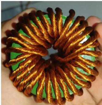
Gambar 12. Induktor 1mH yang digunakan
