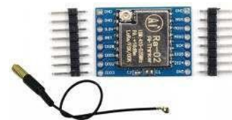
Gambar 4. Bentuk fisik LoRa RA 02 SX 1278
