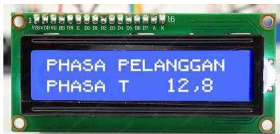
Gambar 15. Contoh Tampilan Hasil Pendeteksian Fasa
