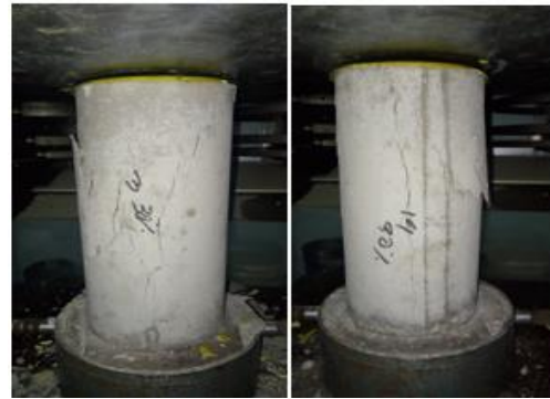
Gambar 11. Benda Uji Variasi 30% setelah Uji Tekan
