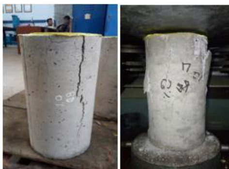
Gambar 10. Benda Uji Variasi 0% setelah Uji Tekan
