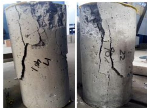
Gambar 12. Benda Uji Variasi 40% setelah Uji Tekan
