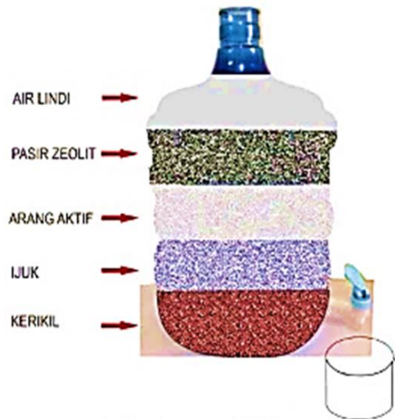
Gambar 1. Rancangan proses filtrasi air lindi.
