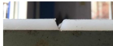
**Gambar 3.** Persiapan sudut *V-groove* pada spesimen
