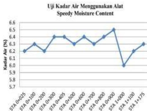
**Gambar 4.** Grafik pengujian kada air
