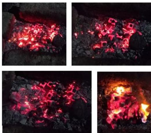
Gambar 2 Proses Pengujian Briket Arang GLACAROL
