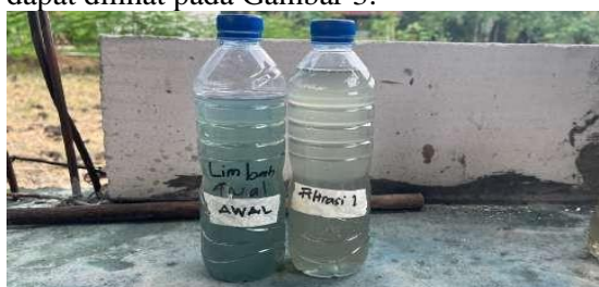
Gambar 3. Penampakan limbah cair batik sebelum dan sesudah diolah dengan filtrasi-adsorpsi
