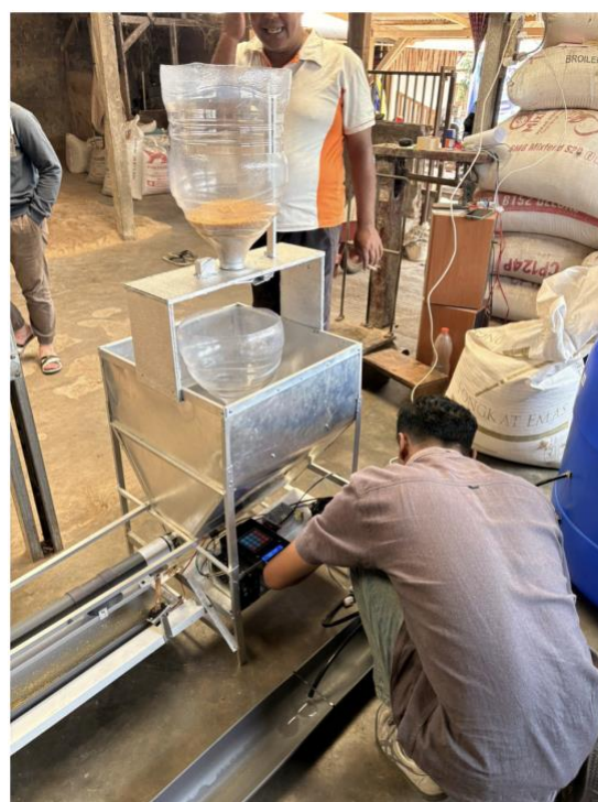
Gambar 2. Alat Tempat Pemberi Pakan dan Minum Otomatis
