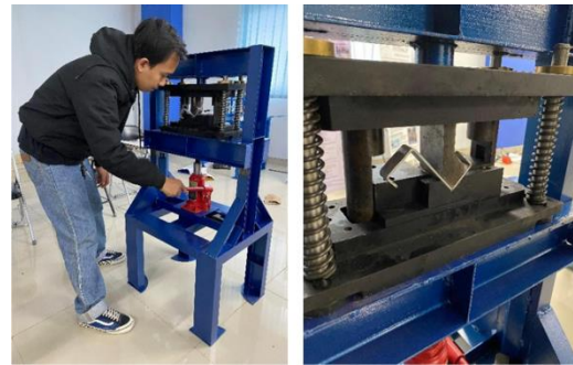
Gambar 6. Uji coba pembengkokan penggantung pakaian dengan perangkat pemotong, pembengkok-penggencet pelat logam
