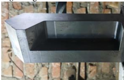
Gambar 5. Hasil pemesinan punch pembengkok-penggencet pelat
