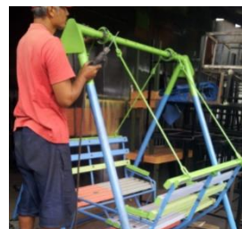
Gambar 13. Penyetelan bantalan gelinding penggantung kursi ayunan oleh tukang las
