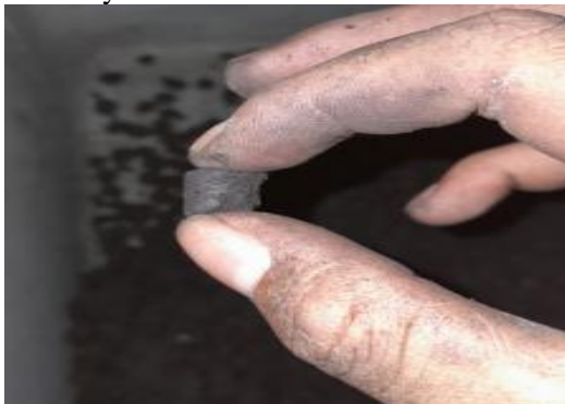
Gambar 12. Hasil Pembuatan Briket dari Abu Arang Kayu Bercampur Tepung Tapioka dan Air yang Cukup Padat
