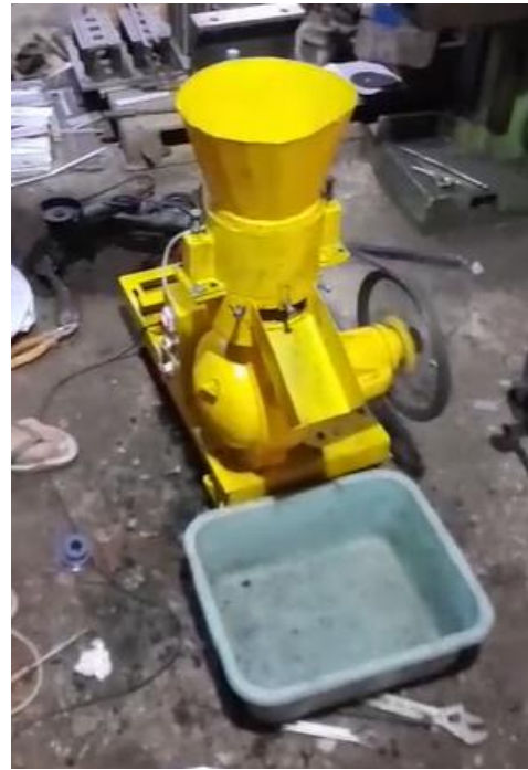
Gambar 8. Mesin pembuat briket dari abu arang kayu menjadi produk berdiameter 8 mm atau 12 mm
