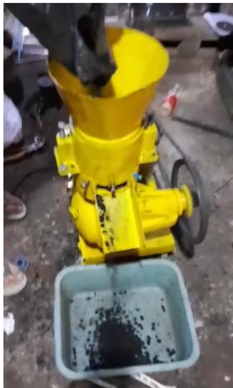
Gambar 9. Hasil uji coba dari mesin pembuat briket dari abu arang kayu untuk produk berdiameter 8 mm
