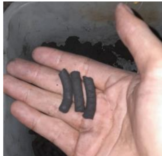
Gambar 13. Hasil Pembuatan Briket dari Abu Arang Kayu Bercampur Tepung Tapioka dan Air yang Berbentuk Silindris Memanjang
