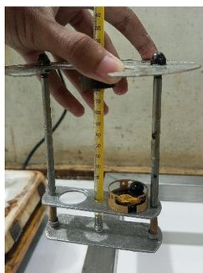
Gambar 14. Rangkaian alat uji titik lunak
