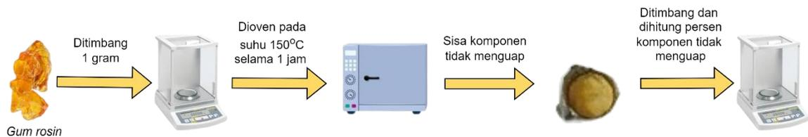
**Gambar 12.** Ilustrasi proses pengujian komponen tidak menguap *gum rosin*
