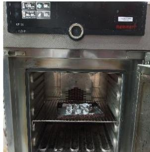
**Gambar 11.** Pemanasan dengan oven untuk uji komponen tidak menguap *gum rosin*
