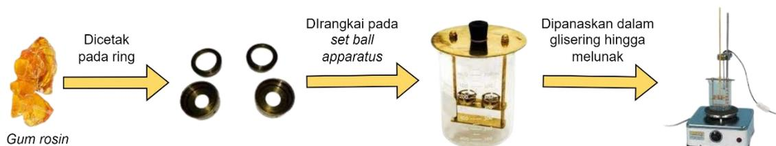
Gambar 15. Ilustrasi proses pengujian titik lunak *gum rosin*
