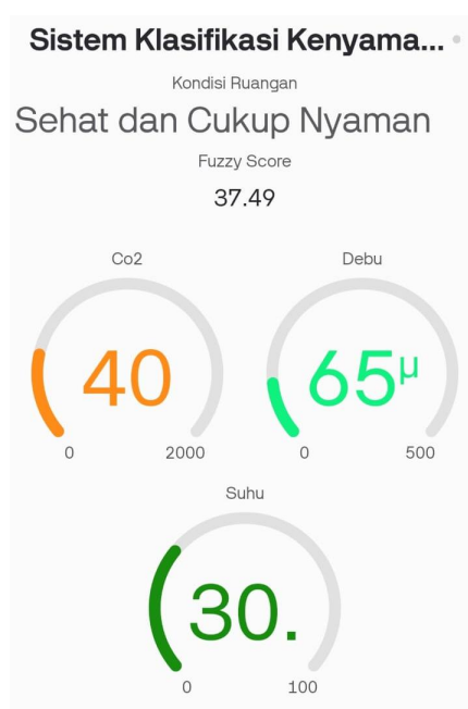
Gambar 8. Tampilan Monitoring Sistem Menggunakan Platform Blynk IoT
