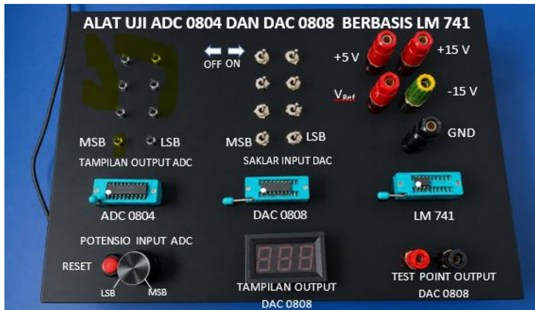
Gambar 5: Tampilan alat uji terpadu ADC0804 dan DAC0808–LM741
