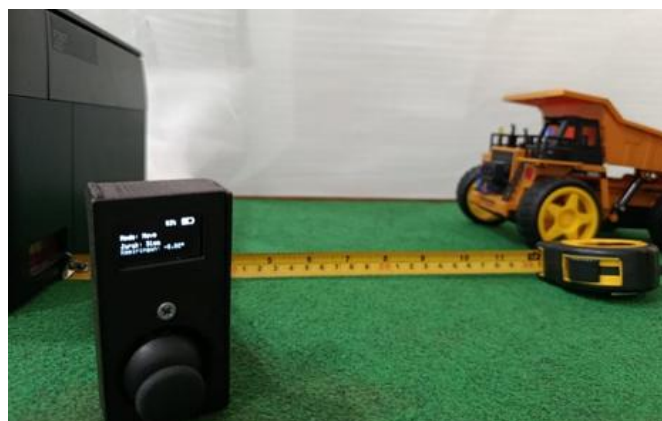
Gambar 6 : Simulasi Jarak Miniatur RC Heavy Dump Terhadap objek didepan RC
