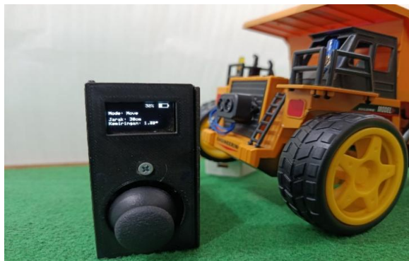
Gambar 7 : Simulasi Kemiringan Miniatur RC Heavy Dump
