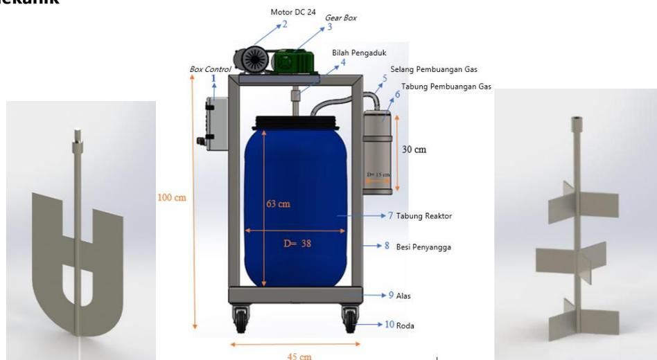
Gambar 3: Perancangan Mekanik Sistem Pengaduk A (*Paddle*), Pengaduk B (Turbin)
