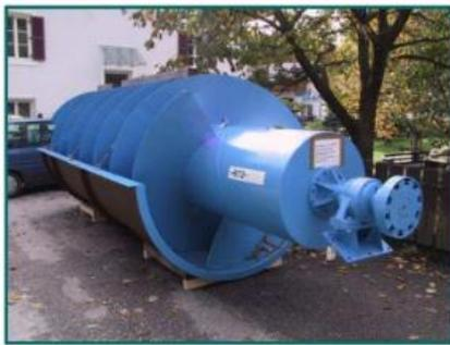
Gambar 2. Bentuk Fisik Turbin Air
