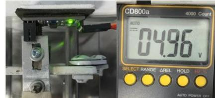
**Gambar 14** Hasil Pengujian Sensor *Optocoupler* dengan *Volt Meter* Terhalang Pembatas
