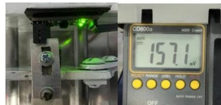
**Gambar 15** Hasil Pengujian Sensor *Optocoupler* dengan *Volt Meter* Tidak Terhalang Pembatas
