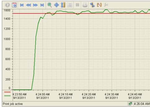
**Gambar 8.** Pengujian PID tanpa beban dengan kecepatan 1500 rpm
