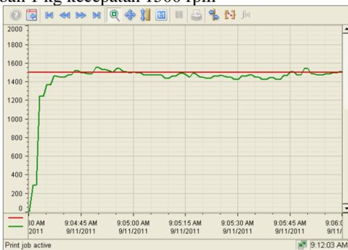
**Gambar 9.** Pengujian PID beban 1 kg dengan kecepatan 1500 rpm
