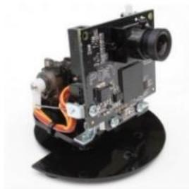
Gambar 1. Sensor Kamera CMUCam 5
