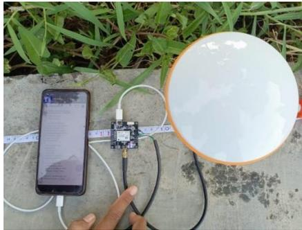
Gambar 4. Pengujian Modul GNSS U-Blox ZED F9P dengan RTK
