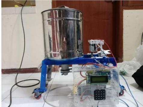
Gambar 4: Bentuk Fisik spinner peniris minyak
