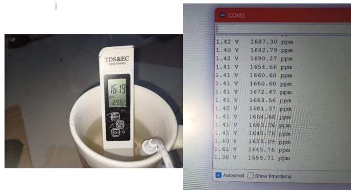
Gambar 6. Pengujian Sensor Pada Air Kolam Kotor
